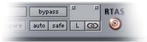
Figura 2: sezione per scollegare i canali left e right in tutti i plug-in
